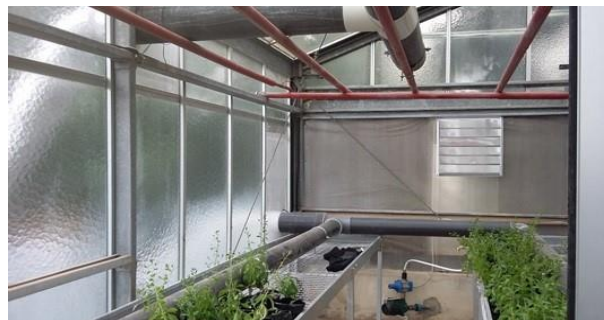
La serre expérimentale de l'INRGREF avec le nouveau dispositif de dissipation thermique aux côtés du système d'absorption
