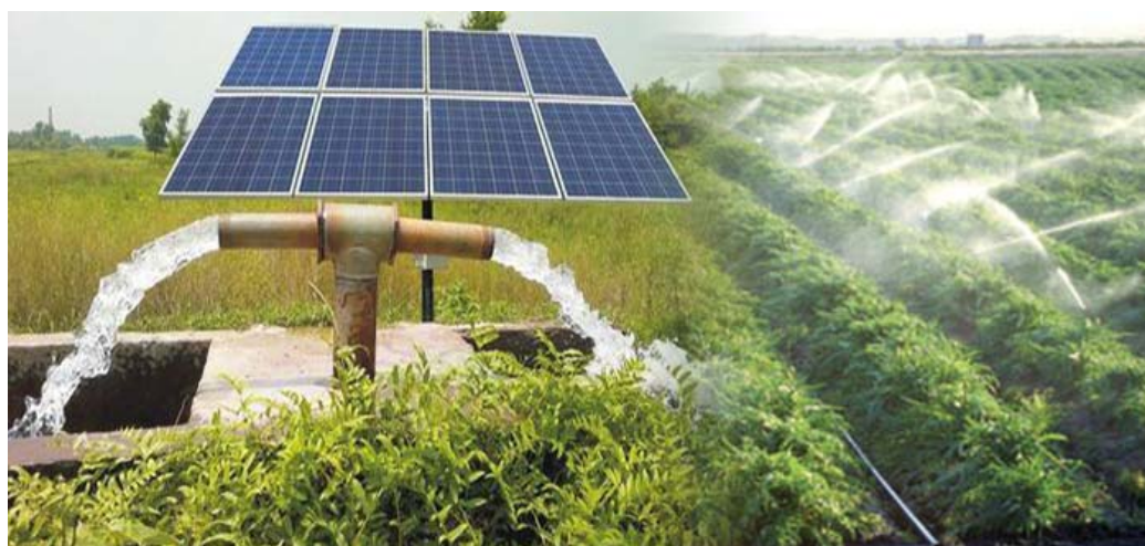
Figure 9:Exemple de pompage PV au fil de soleil
