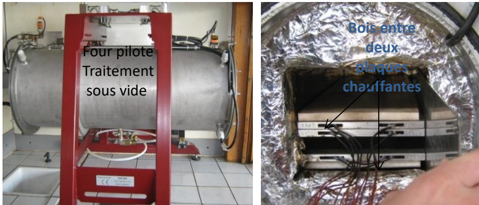
Figure 5: Processus du traitement thermique dans le four pilote.
