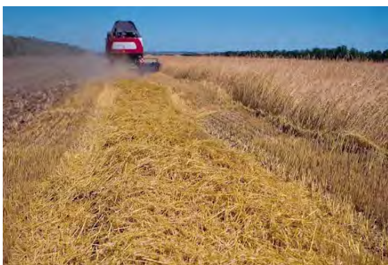
Photo 2 : Perte sur la largeur de coupe
