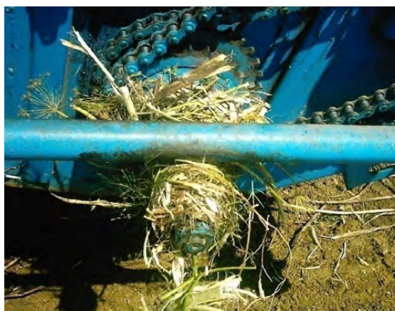
Photo 11 : Bourrage due aux mauvaises herbes lors de la récolte
