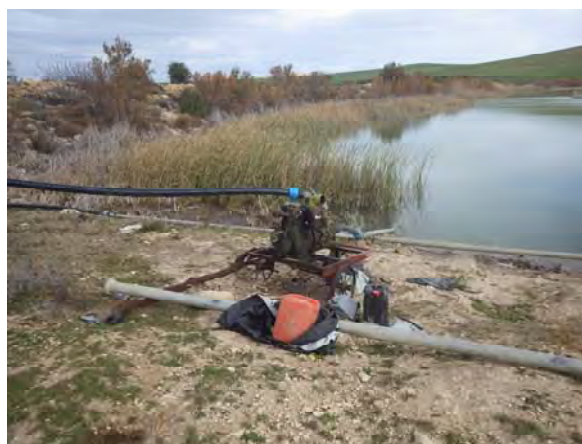
Pompe de refoulement à partir du bassin de retenue
