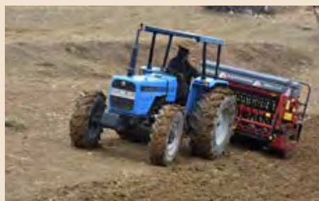
Photo n° 48 Semis direct (sans préparation du lit des semences)
