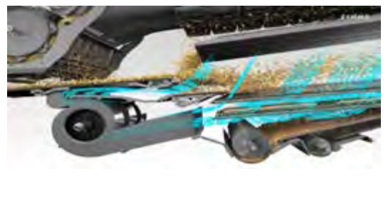
Photo n° 2 Principe de fonctionnement d'une moissonneuse batteuse
