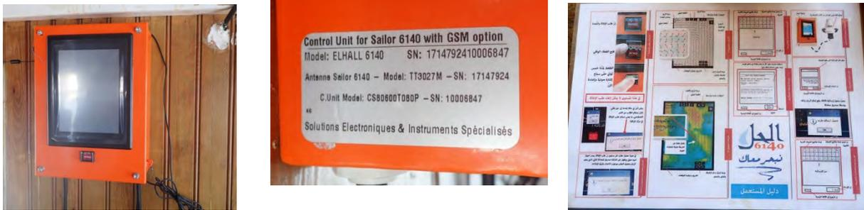
Photos 1-2 Émetteurs VMS installés dans la timonerie de bateaux de pêche privés, et guide d'utilisation
